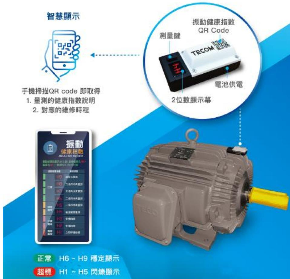
東元智慧馬達具備振動顯示功能，IE3 超高效率鑄鐵殼馬達標準搭配智慧自帶屏振動規 VB-100 系列，不須額外供電以及拉線，即可提供振動運轉數值，掃描 QR Code，所顯示的馬達健康狀況及維修時程建議，皆為依照 ISO 10816 國際法規標準。
